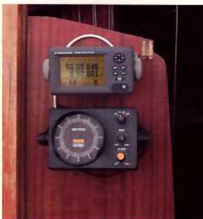
Twee belangrijke instrumenten op het zeilschip: de GPS voor de plaatsbepaling (boven) en de dieptemeter (onder).
